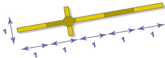
En visant dans les directions définies par MC et par MD, on imagine, connaissant MH, HC et HD pouvoir calculer des hauteurs et des distances, grâce à une application élémentaire du théorème de Thalès.
