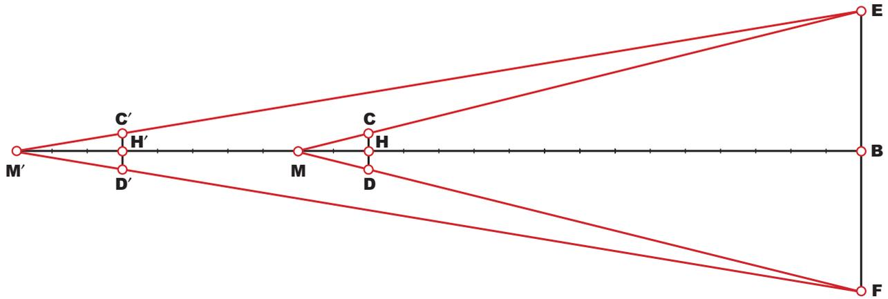
Sur la figure schématique ci-dessus, on a en effet l'étonnante propriété : si, de M, on voit [EF] sous [CD] lorsque MH vaut 2, et si de M', on voit [EF] sous [C'D'] lorsque M'H' vaut 3, alors on a exactement  $2M'M = MB$  !!!
